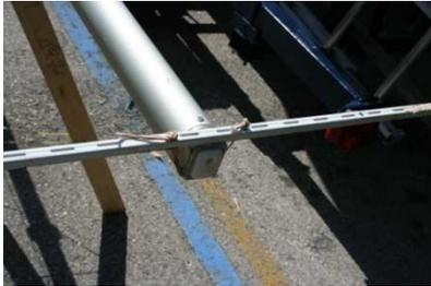
Nach der Einstellung des Salingwinkels müsst ihr überprüfen ob die Salinge 90 Grad zum Mastfuß stehen Den Gummi lasst ihr noch auf den Salingen gespannt und fixiert eine lange Latte am Mastfuß(siehe Bild)
