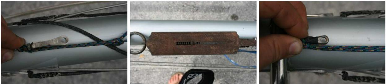
nach: Legt den Mast am Fockfallpunkt und an der unteren Messmarke auf 2 Böcke auf mit der Nut nach unten. Nehmt die Oberwanten an der Vorderseite des Mastes - zieht mit einer Federwaage mit 15 kg und markiert die untere Innenseite des Terminals mit einem Bleistift. Prüft ob die Längen gleich sind, wenn nicht bestellt neue Oberwanten mit gleicher Länge beim Mastbauer!
